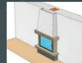
Implantation idéale si le conduit passe dans l'épaisseur du mur et s'ouvre à hauteur de foyer dans la pièce
